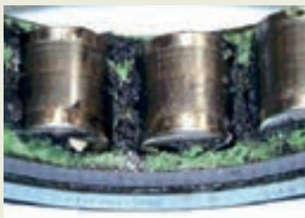
Degradacja smaru spowodowana prądami wyładowań elektrycznych
